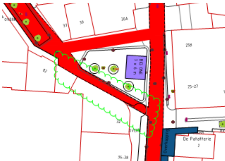
Figuur 4: Oorspronkelijk aangegeven calamiteitenroute (groen omkaderd) is onvoldoende breed, alternatief is om deze te verleggen naar de bovenzijde van het plein. Dit dient aangepast te worden op de tekening van de calamiteitenroute.
